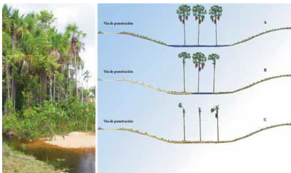
Figura 10. Las carreteras en los bordes de los valles causan erosión y arrastre de sedimentos que al depositarse sobre las raíces aéreas de las palmas originan su muerte. Fuente: González (2009).
