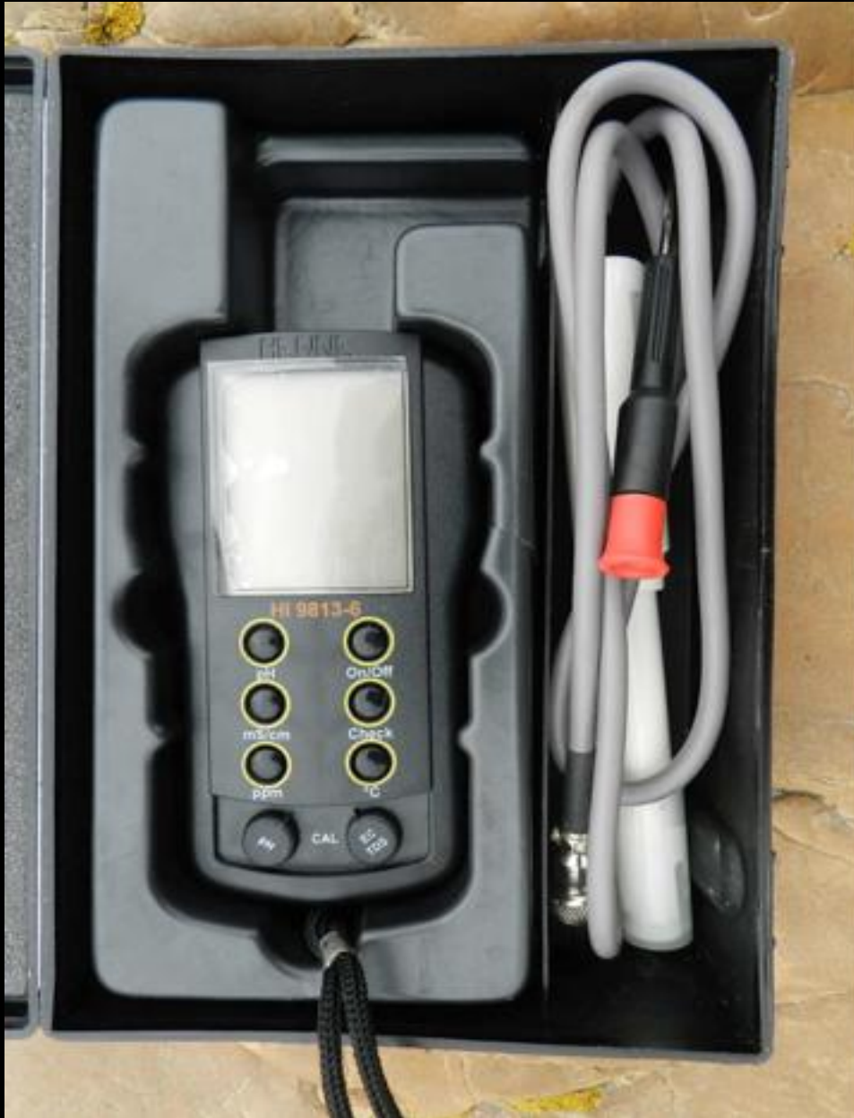
Figura 4. Equipo multiparámetro ¿Qué miden los equipos?
