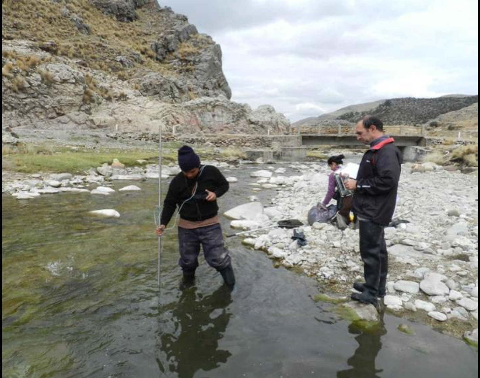
Figura 6. Medición de datos velocidad, profundidad y sustrato.
